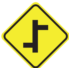
Empalmes contrarios sucesivos
